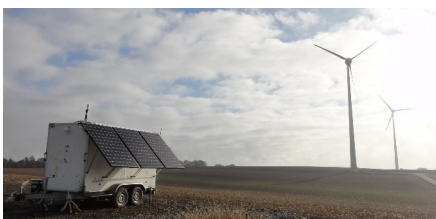
Analyse de performance (campagne LIDAR, vérification courbe de puissance, occurrence de défauts de composants...)
